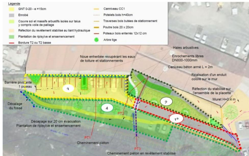
Figure 3 : Plan de composition d'ensemble du projet (PA3.1)
