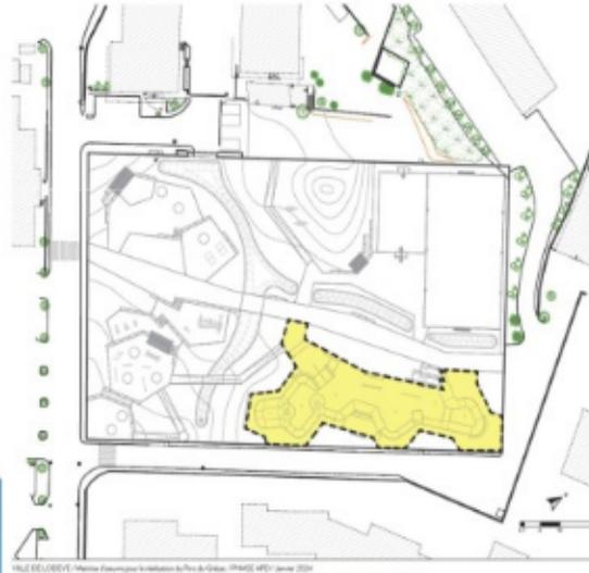
Entièrement réalisé en béton foncé, le skatepark occupe une surface d'environ 980 m<sup>2</sup>, et sera équipé à l'angle nord-est de la parcelle, le plus éloigné possible de l'axe de circulation de la voirie, et adjacent depuis l'axe en diagonale également adjoint au bâtiment.
