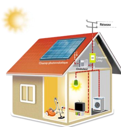
Installation en autoconsommation
